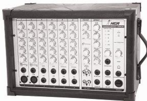
Cabeçote com vários canais com equalização independente. Note o XLR.
