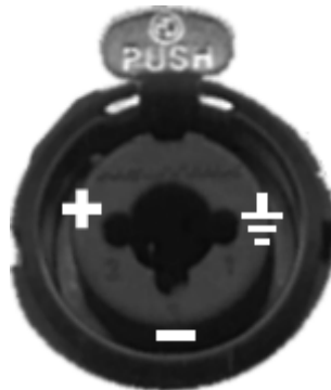
Conector Combo – aceita XLR macho e P10 macho
