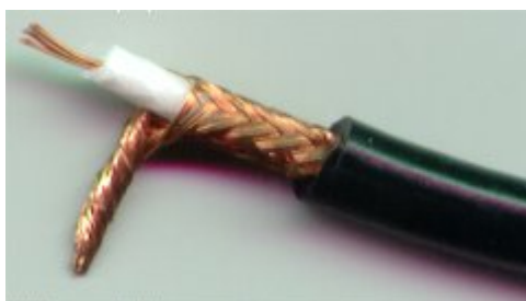
Cabo Coaxial – repare que o condutor externo envolve totalmente o interno
