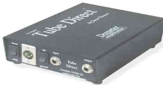
Direct Box. À direita, a entrada P10, à esquerda a saída XLR e no meio uma saída P10 (“emendada” com a entrada) para permitir a ligação com um cubo.
